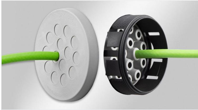
Die Kabeldurchführungsplatten KEL-DPZ-CLICK ermöglichen es, auf engstem Raum sehr viele Leitungen, auch mit unterschiedlichen Durchmessern von 1.5 bis 22 mm einzuführen und 2-fach gemäß IP65 / IP66 / IP68 (zertifiziert nach DIN EN 60529) abzudichten. Gleichzeitig werden die durchgeführten Leitungen zugentlastet.
